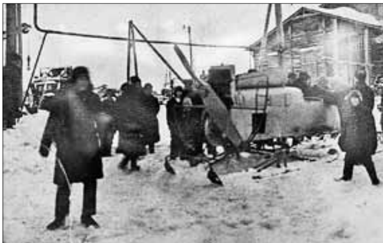
■ Аэросани, изготовленные на заводе «Красная Кузница» в годы войны, после испытания. ФОТО: МУЗЕЙ ЗАВОДА «КРАСНАЯ КУЗНИЦА»
